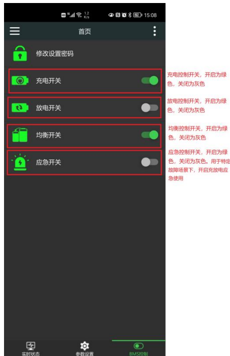
图 12 BMS控制页 Figure 12 BMS control page
